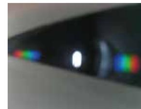
En el interior del tubo o de la caja, a ambos lados de la ranura, vamos a observar un rectángulo con los colores del "arco iris". El ancho del rectángulo será igual a la longitud de la ranura. Cuanto más delgada la ranura el espectro será más definido.
