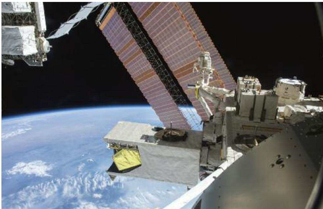
*Laboratorio de experimentos japonés JEM-EF, en la ISS. Sector de plataforma expuesta al vacío que contiene unos diez experimentos.*
